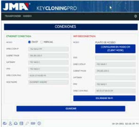
Sobald die Seite geöffnet ist, ändern Sie die Konfiguration des WLANs an der EvoXpert (Voreinstellung ist der AP-Modus) und klicken auf Wi-Fi-SCAN.
