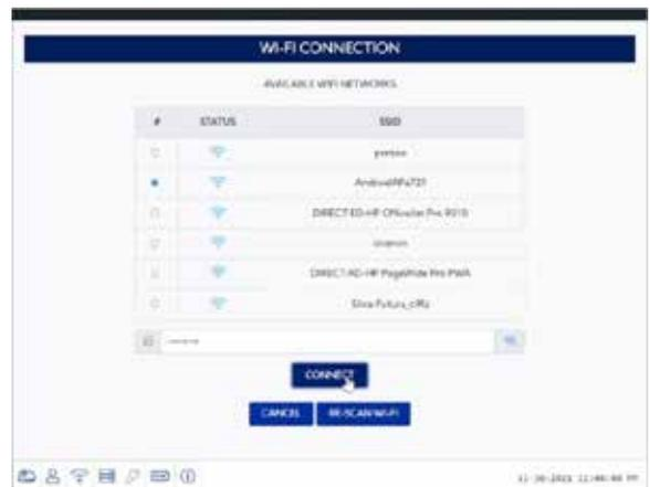
Sobald Sie die Taste VERBINDEN angeklickt und abgewartet haben, bis sich die EvoXpert zurückstellt (die Status-LED schließt den Zyklus Grün-Rot-Grün ab), ist die WLAN-Verbindung Ihrer EvoXpert konfiguriert, um sich mit dem WLAN des Smartphones als Hotspot zu verbinden.
