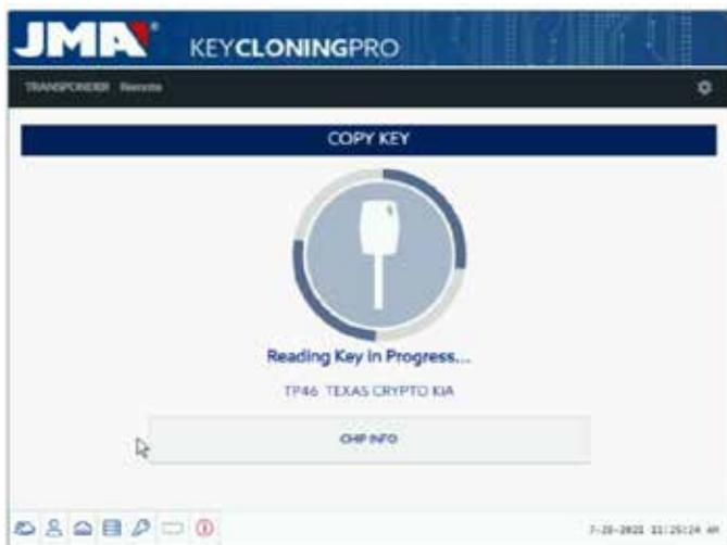
Dans cet exemple de lecture, il s'agit d'une KIA Optima intégrant une technologie de clé basée sur les Texas DST80 et de type DST80-FAST, compte tenu du temps de calcul nécessaire dans les serveurs de JMA. D'autres modèles du groupe HYUNDAI-KIA/FORD/MAZDA sont également du type DST80-FAST.
