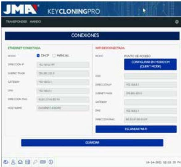
Une fois sur la page, cliquez sur « Scanner Wi-Fi » pour modifier la configuration Wi-Fi de votre EvoXpert (qui est établie par défaut en Mode PA). La page « Connexion Wi-Fi » se charge.
