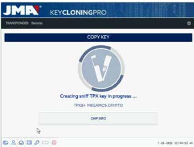
Wenn die Änderung des Betriebsmodus korrekt ausgeführt wird, erscheint das folgende Menü, in dem die Datenerfassung am Lenkradschloss des Fahrzeugs ausgeführt wird.
