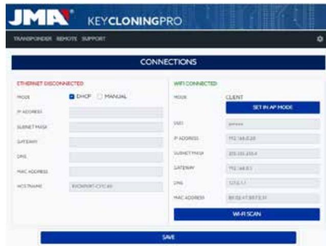
После подключения EvoXpert по Wi-Fi к маршрутизатору клиента остается только подключить устройств, используемое в качестве дисплея (мобильный/планшет/ПК/ноутбук), к той же сети Wi-Fi роутера клиента, так как непременным условием нормальной работы является нахождение EvoXpert и устройства, используемого в качестве дисплея (мобильный/планшет/ноутбук) в одной сети.
