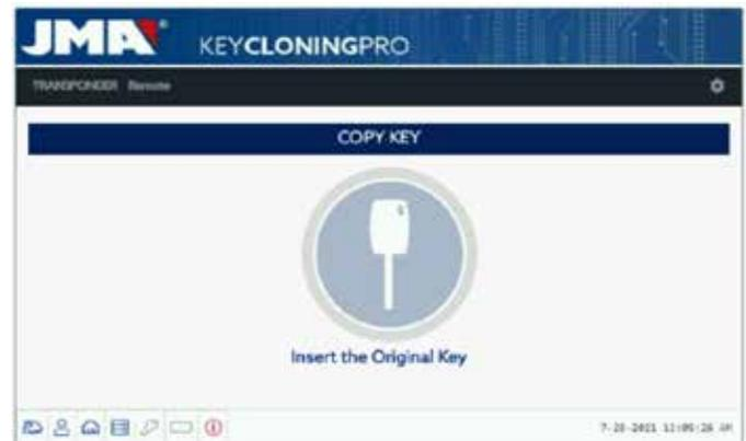
Wenn die Datenübertragungen korrekt sind, geht der Vorgang entweder zum Status (**Schlüsseldaten in der Warteschlange**) über, je nachdem, ob andere Personen, zur gleichen Zeit Schlüssel desselben Typs (Megamos) bearbeiten, oder zum Status (**Schlüssel wird bearbeitet**), wenn keine Warteschlange besteht.
