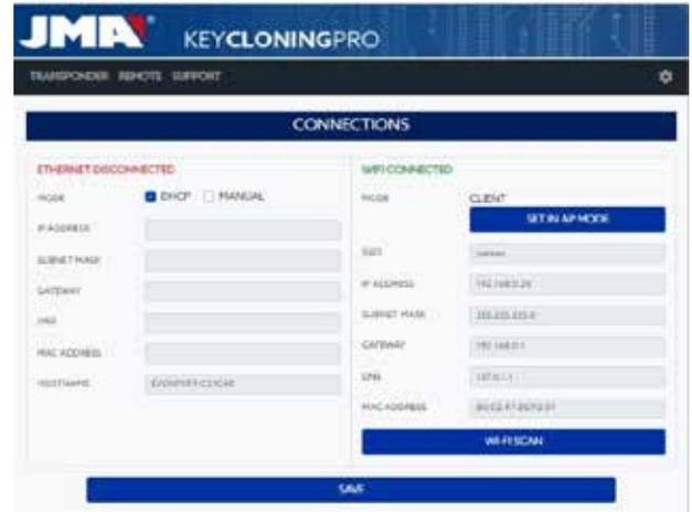
Pour terminer, une fois votre EvoXpert connectée au routeur Wi-Fi, vous devez connecter l'appareil que vous souhaitez utiliser comme écran (téléphone portable, tablette, ordinateur portable, etc.) au même routeur de réseau Wi-Fi, car il est impératif que l'appareil utilisé comme écran et l'EvoXpert soient connectés au même réseau Wi-Fi. Une fois les deux appareils connectés au même réseau, vous pouvez alors connecter votre EvoXpert au moyen de n'importe quel navigateur Web.
