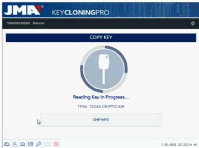
In diesem Fall wird die Ableseung eines KIA Optima mit Schlüsseltechnik auf Grundlage der Texas DST80 und des Typs DST80-FAST für die Berechnungszeit angezeigt, die die Server von JMA benötigen.
