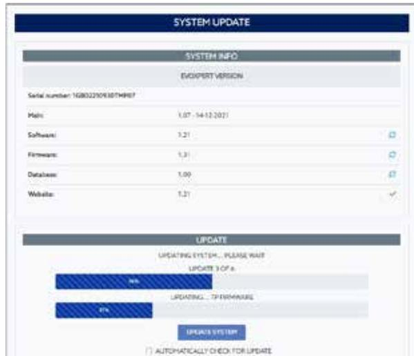
Una vez finalizado el proceso de actualización, la EvoXpert se reinicia automáticamente, y una vez completado el proceso, ya la tendríamos completamente actualizada.
