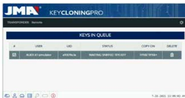
Po pozyskaniu danych z pojazdu (zob. kanał JMA w serwisie YouTube zawierający szereg filmików instruktażowych dotyczących urządzenia TRS-EVO i sposobu pozyskiwania sygnałów z pojazdu) urządzenie EvoXpert przypisuje pozyskane sygnały do danego klucza w panelu sterowania klienta na podstawie identyfikatora klienta:
