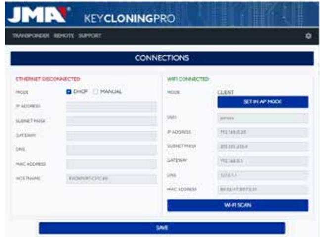
Com a máquina EvoXpert ligada por Wi-Fi ao router do cliente, só faltaria ligar o dispositivo que se vai usar como ecrã (telemóvel/tablet/PC/portátil) à mesma rede Wi-Fi do router do cliente. É uma condição sine qua non que tanto a EvoXpert como o dispositivo usado como ecrã (telemóvel/tablet/PC/portátil) estejam ligados à mesma rede.
