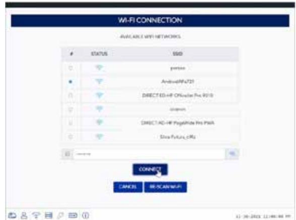
После нажатия кнопки ПОДКЛЮЧИТЬ и ожидания перезагрузки EvoXpert (индикатор статуса завершает цикл «зеленый-красный-зеленый»), Wi-Fi соединение EvoXpert настраивается на работу с Wi-Fi мобильной точки доступа Hotspot.
