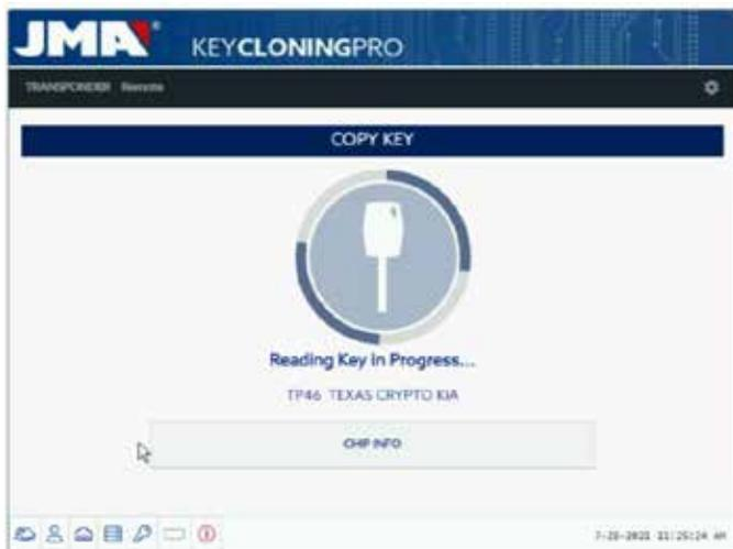
В данном случае нам показано считывание KIA Optima с технологией ключа на основе Texas DST80 и типа DST80-FAST и время расчета на серверах JMA.
