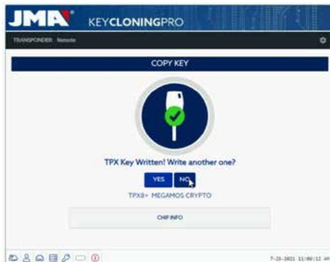
Jeżeli użytkownik nie chce przystąpić do wykonania kolejnej kopii, należy wybrać „NIE”, aby usunąć klucz z aktualnego procesu przetwarzania kluczy na serwerze oraz z panelu sterowania zadaniami klienta.
