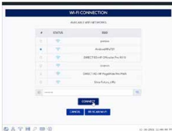
Po naciśnięciu przycisku POŁĄCZ i zresetowaniu urządzenia EvoXpert (sekwencja diody statusu: zielony-czerwony-zielony) połączenie urządzenia EvoXpert byłoby już skonfigurowane w trybie Wi-Fi, umożliwiając wykorzystanie sieci stworzonej w ramach hotspotu do wykonania pracy.
