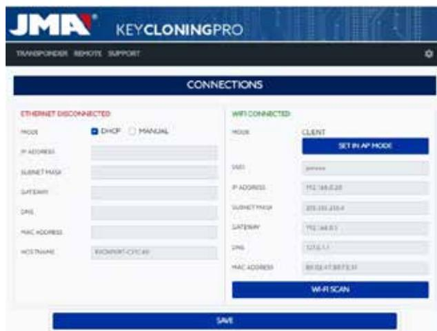
Estando la EvoXpert conectada via Wi-Fi al router del cliente, tan solo nos quedaría conectar el dispositivo que se vaya a utilizar como Display (móvil/ Tablet/PC/Laptop) a la misma red Wifi del router del cliente, ya que es condición sine qua non, que tanto la EVOXpert como el dispositivo utilizado a modo de Display (móvil/Tablet/laptop), han de estar en la misma red. Una vez que ambos estén en la misma red, ya podríamos conectarnos con nuestra EvoXpert desde cualquier navegador Web.
