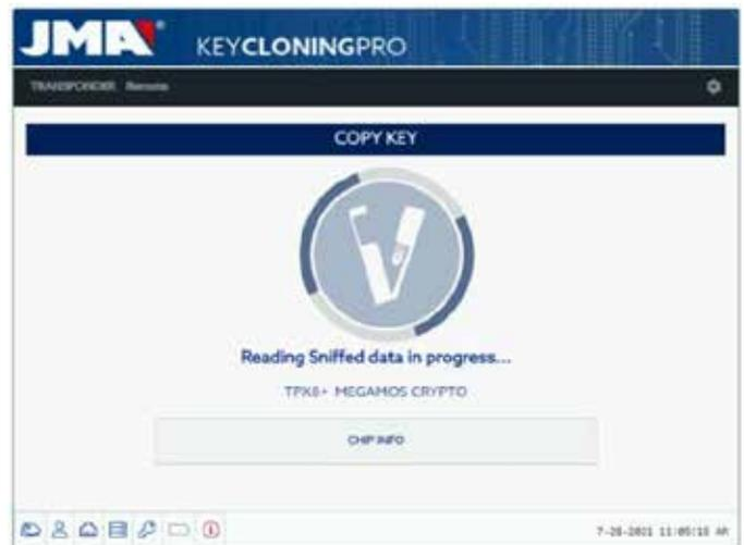
После считывания данных, вставьте оригинальный ключ для сбора вызовов-ответов, т.е. информация, отправляемая на сервер вычислений:
