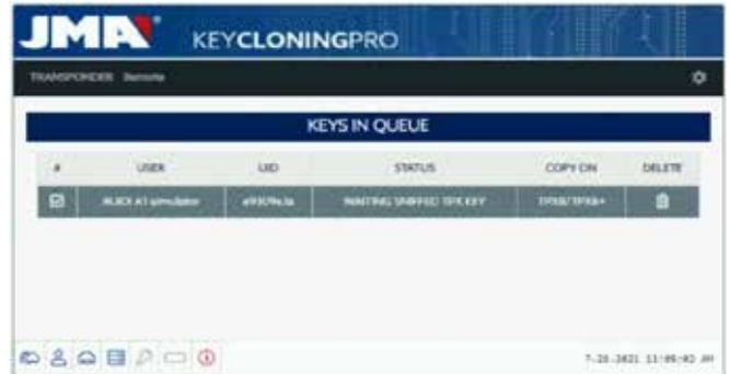
После сбора данных (см. канал JMA на youtube с различными видеороликами по сбору sniffеры, уже опубликованными ранее для TRS-EVO), EVOXPERT определяет, какому из ключей в панели управления клиента соответствуют считанные sniffеры в соответствии с ID ключа:
