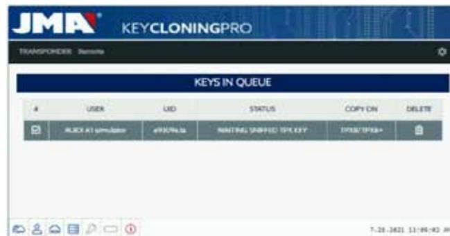
Siguiendo con el proceso de copia, se procede a cambiar los ajustes del chip y ponerlo en modo SNIFF, para así poder recoger algunos datos en el clausor del vehículo.
