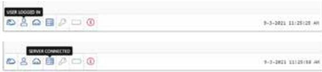
Une fois les 3 étapes précédentes terminées, (dans l'exemple de l'EVOXPERT utilisée), les 4 premières icônes de la barre inférieure s'activent. En cliquant sur l'icône « Outils » (à droite sur la barre de menu supérieur), vous pouvez accéder au menu déroulant et sélectionner l'option « Connexions » pour afficher les paramètres de communication décrits de manière détaillée à la section 4 ci-après.
