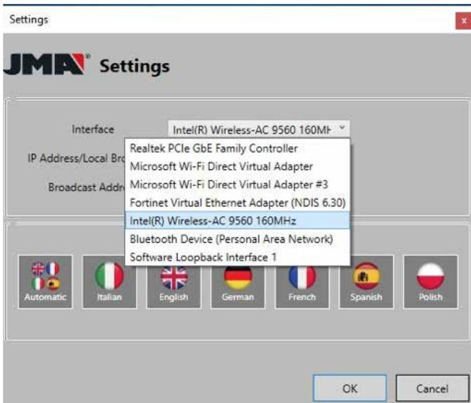
Если бы мой ноутбук был подключен к маршрутизатору через кабель Ethernet, мне пришлось бы подключиться с помощью сетевой карты моего ПК, которая в моем случае называется:
