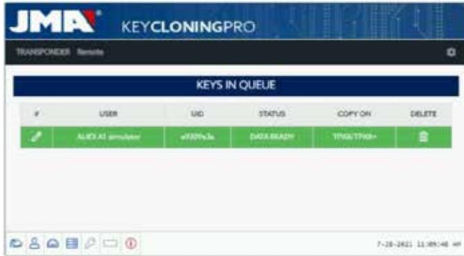
Wenn Sie diesen Vorgangstatus erreicht haben, in dem der Server den Code des Schlüssels gefunden hat, gibt es 2 Möglichkeiten, mit dem endgültigen Kopiervorgang auf den Transponder-Rohling von JMA fortzufahren, dies wird auf dem Bedienfeld im Absatz Kopieren auf TPX8/TPX+ angezeigt.
