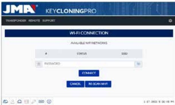
Von dieser Seite (nach Anklicken von WLAN ERNEUT SCANNEN) scannen Sie alle WLAN-Netze, die sich in Reichweite der EvoXpert befinden (Es können keine WLAN-Netze im verborgenen Modus konfiguriert werden).
