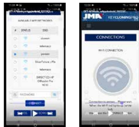
Na etapie automatycznego resetowania urządzenia EvoXpert z zastosowaniem nowych ustawień sieci Wi-Fi klienta należy poczekać z wykonaniem ponownego skanowania urządzeń połączonych z aplikacją JMA Key Cloning Pro do czasu, aż dioda statusu wykona sekwencję zielony-czerwony-zielony.
