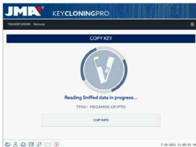
Po odczycie zebranych danych urządzenie prosi o wprowadzenie klucza oryginalnego w celu pozyskania poszczególnych sygnałów-odpowiedzi, które zostaną przesłane na serwer obliczeniowy:
