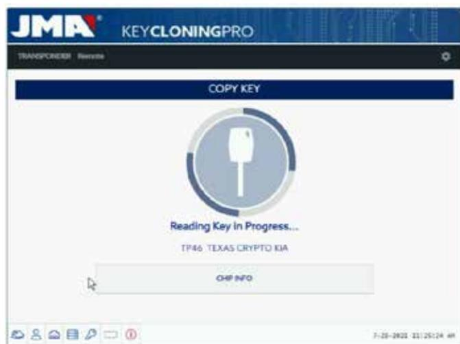
En este caso, se nos muestra la lectura de un KIA Optima con tecnología de llave basada en los Texas DST80 y del tipo DST80-FAST, por el tiempo de cálculo que viene a tardar en los servidores de JMA.
