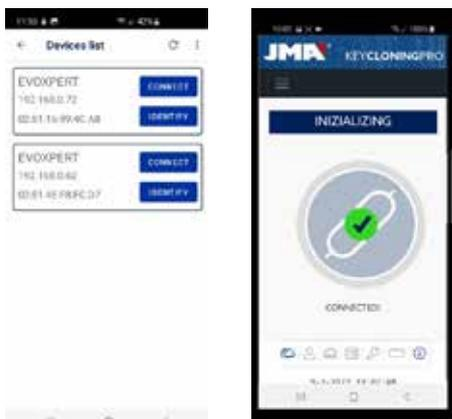
Una vez presionado el botón CONNECT, y tras esperar hasta que la EvoXpert se resetee (Led de Status completa el ciclo Verde-Rojo-Verde) ya tendríamos configurada la conexión Wifi de nuestra EvoXpert para trabar con la Wi-Fi del Movil en Hotspot.
